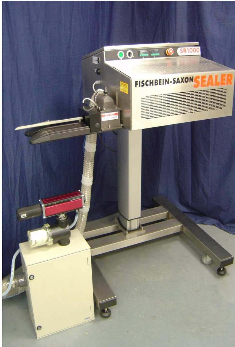
Version de gauche à droite, équipée ici avec un Airwash 1000 pour nettoyage de la partie supérieure du sac.
